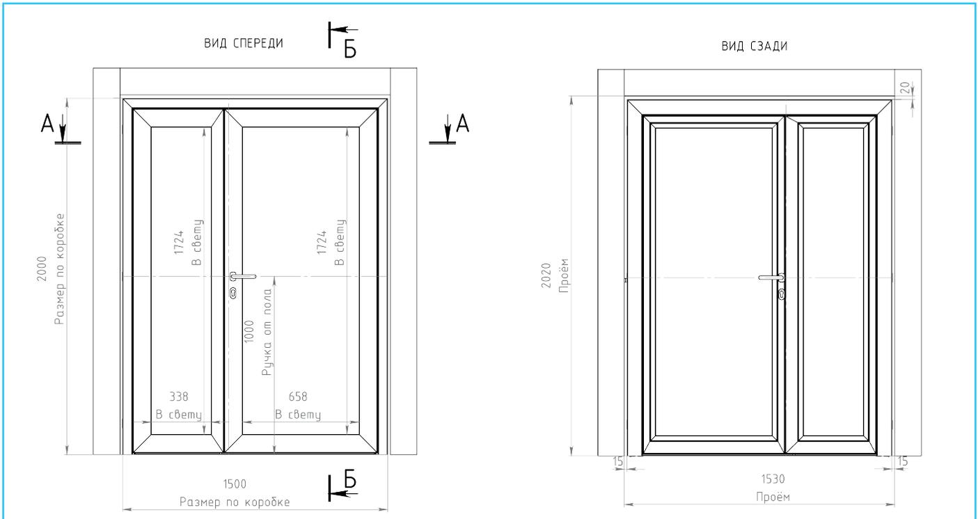
**ДВЕРЬ ПРОТИВОПОЖАРНАЯ EIWS-60 УЗКОПРОФИЛЬНАЯ С ОСТЕКЛЕНИЕМ >25% СО СКРЫТЫМИ ПЕТЛЯМИ**
