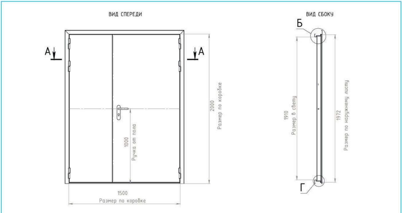
ДВЕРЬ ПРОТИВОПОЖАРНАЯ EIS-60 С ОТДЕЛКОЙ HPL-ПЛАСТИКОМ
