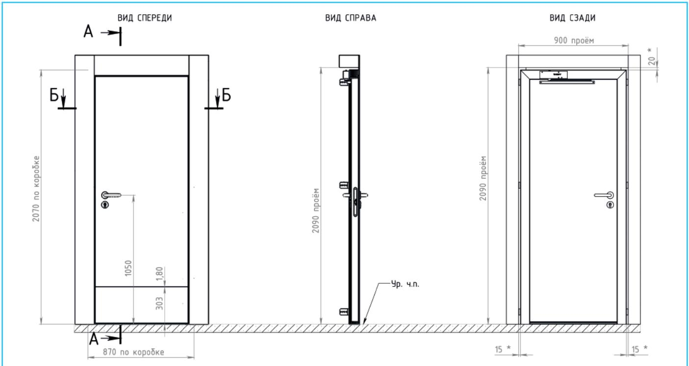
ДВЕРЬ ПРОТИВОПОЖАРНАЯ EIS-60 СКРЫТОГО МОНТАЖА
