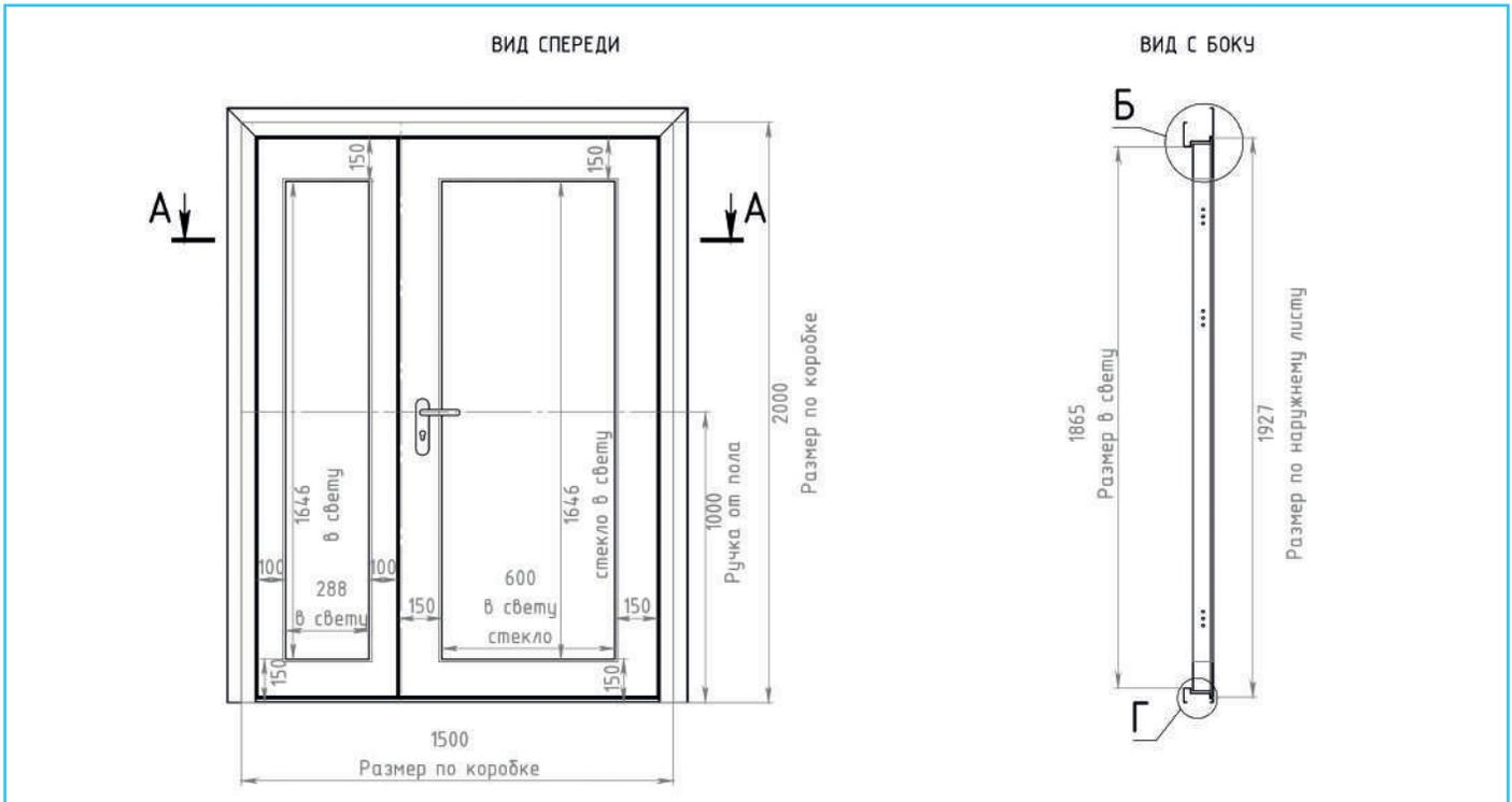
**ДВЕРЬ ПРОТИВОПОЖАРНАЯ EIWS-60 С ОСТЕКЛЕНИЕМ >25% СО СКРЫТЫМИ ПЕТЛЯМИ**
