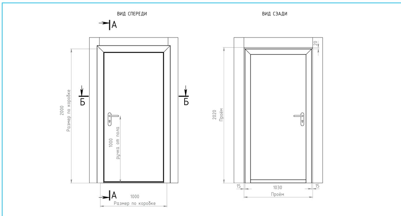
ДВЕРЬ ПРОТИВОПОЖАРНАЯ EIS-60 СО СКРЫТЫМИ ПЕТЛЯМИ
