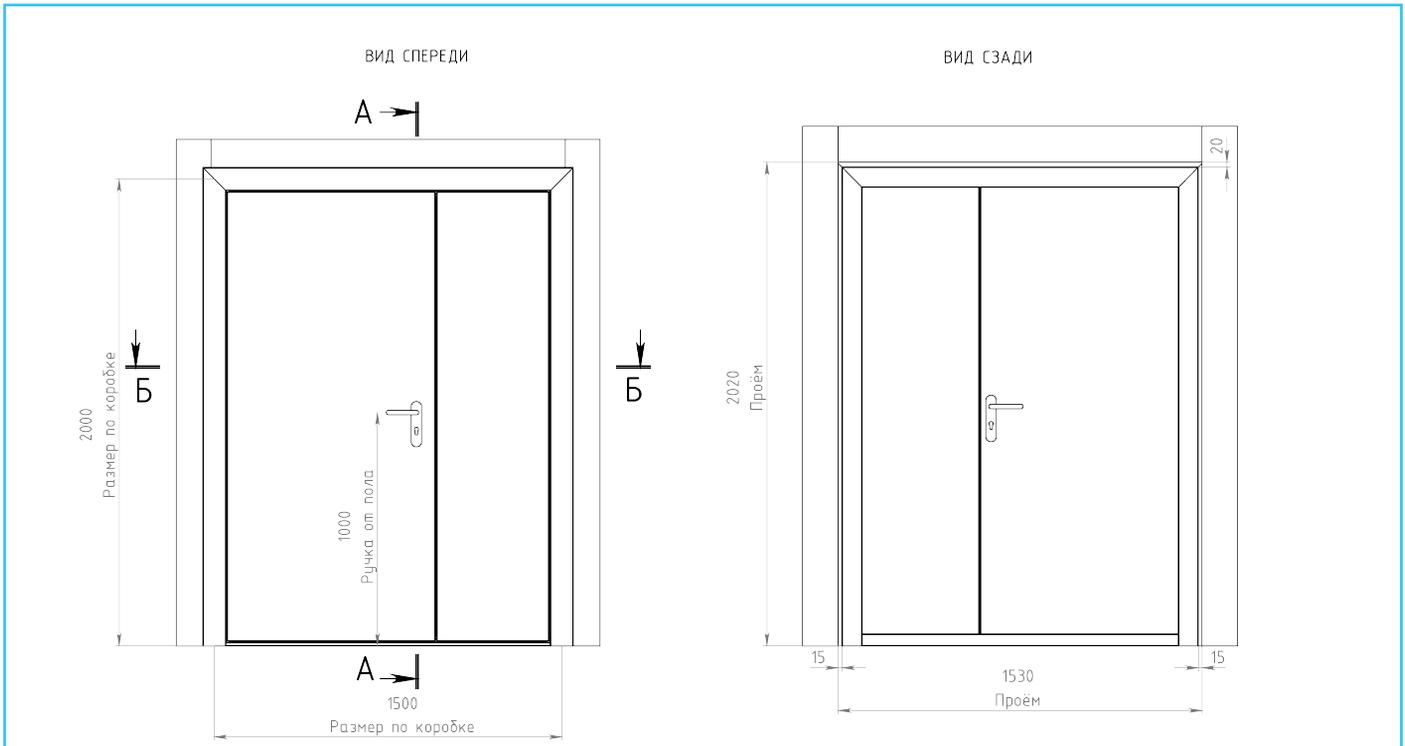
ДВЕРЬ ПРОТИВОПОЖАРНАЯ EIS-60 СО СКРЫТЫМИ ПЕТЛЯМИ
